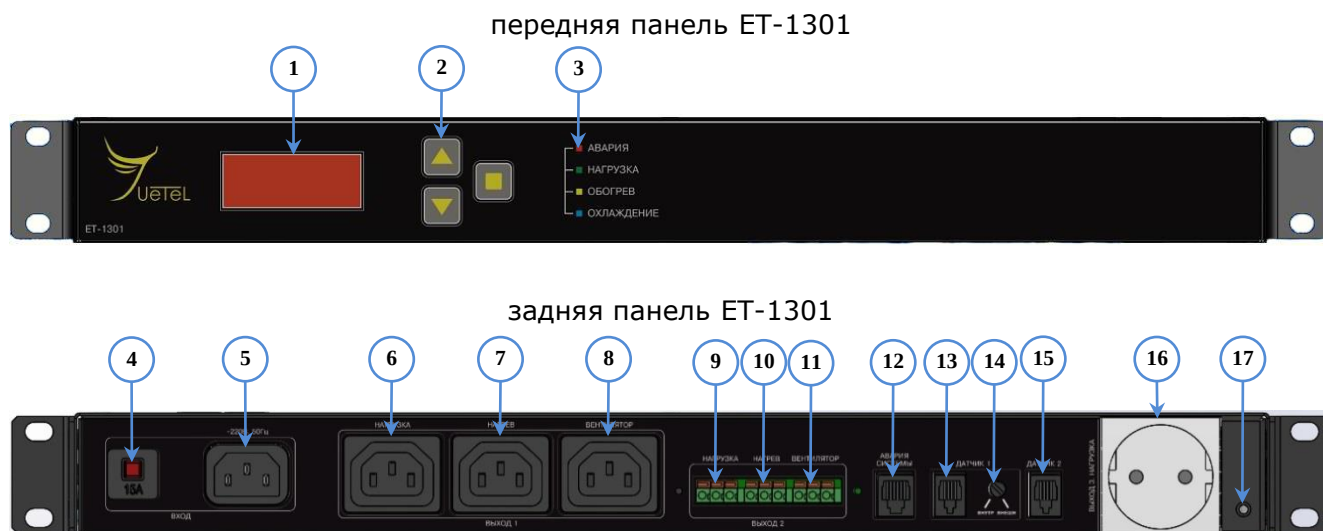
Рисунок 1 – Электронный термостат ET-1301: 1 – светодиодный дисплей; 2 – кнопки управления; 3 – светодиодная индикация; 4 – тепловой предохранитель общий; 5 – разъем подключения электропитания термостата; 6, 9 – разъем подключения нагрузки; 7, 10 – разъем подключения нагревателя; 8, 11 – разъем подключения вентилятора; 12 – разъем сигнала «Авария»; 13 – разъем подключения внешнего датчика температуры воздуха; 14 – переключатель выбора датчика температуры «внутренний/внешний»; 15 – разъем подключения датчика температуры нагревательного элемента; 16 – розетка для подключения нагрузки; 17 – место для заземления.
